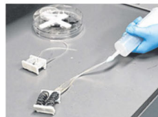
机器人的风箱折纸结构由两条风箱组成，犹如两条腿，在充气 and 抽气下左右延展来行动。
