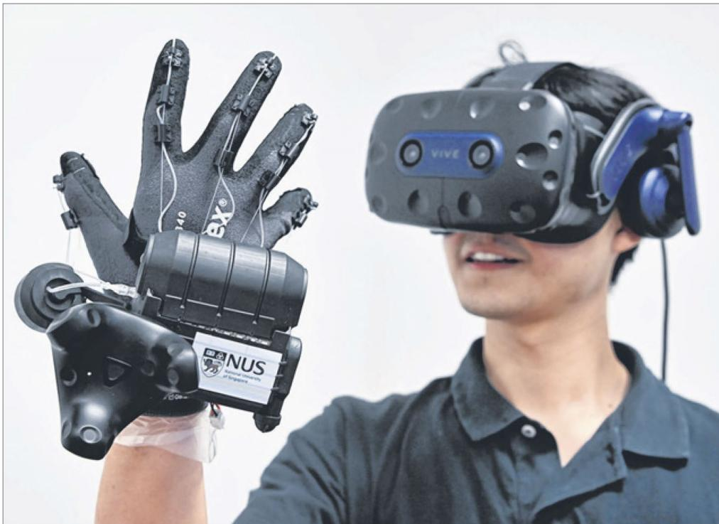
由新加坡国立大学医疗健康创新与科技研究院团队发明的虚拟实境手套，采用微流控传感技术，让使用者在“触碰”虚拟物体时，也能感受到物体形状、大小和软硬度。（海峡时报）
