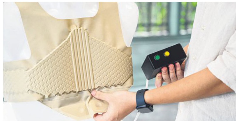
Auxobrace应用软机器人与真空装置原理，抽出背心的空气，背心均匀地随着穿者体型收缩，为胸骨提供最佳的向内支撑与稳固作用。（James Dyson Foundation提供）
