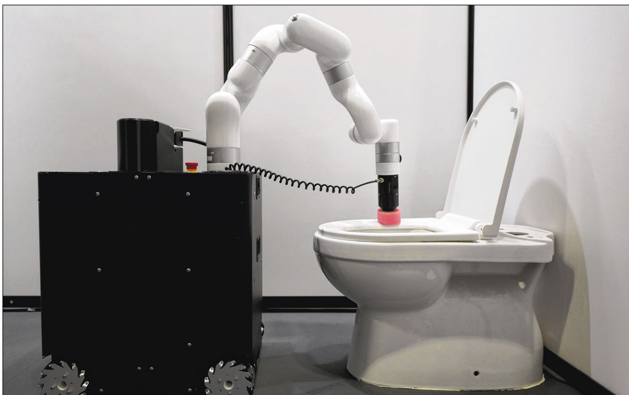
CANGGIH: Robot rekaan syarikat Hivebotics membersihkan tandas menggunakan sistem pembersih wap. – Foto ST
