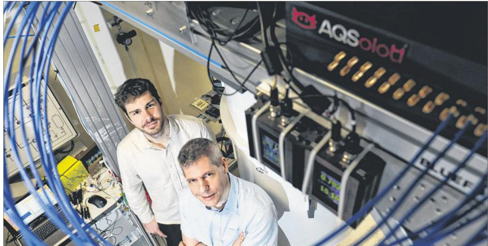
AQSolutl联合创始人兼首席执行官博尔（左）和南大物理学家杜姆克副教授，向记者展示最新研制的量子控制器。图中右上黑色部件为控制器，所释放的电磁波通过蓝色电缆，对处于超低温环境中的量子晶片进行操控，达到计算目的。（何炳耀摄）
